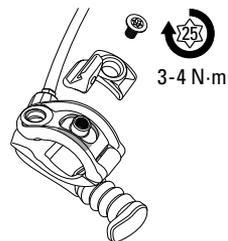
**Remhendel** - Positioneer de remhendel tegen het stuur. Breng de afzonderlijke klem aan rond het stuur en de remhendel. Voeg de afzonderlijke klembout in en draai de bout losjes vast zodat de assemblage wordt samengehouden. Plaats de afzonderlijke klem in de gewenste positie en gebruik een T25 TORX om de klem aan te draaien tot 5-6 N-m.
