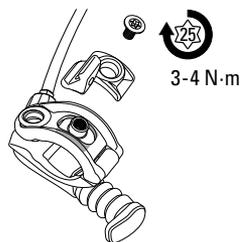
**Bremshebel** - Platzieren Sie den Bremshebel am Lenker. Schließen Sie die Fernbedienungsklemmung um den Lenker und den Bremshebel. Setzen Sie die Fernbedienungsklemmschraube ein und ziehen Sie sie leicht an, um die Baugruppe zusammenzuhalten. Drehen Sie die Fernbedienungsklemmung in die gewünschte Position und ziehen Sie die Klemmschraube mit einem T25 TORX-Schlüssel mit 5 bis 6 N·m an.
