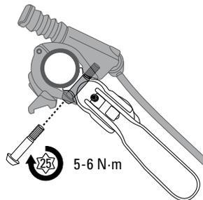
**Schalthebel** - Fixieren Sie den Schalthebel mit der Schalthebel-Befestigungsschraube an der Fernbedienungsklemmung. Ziehen Sie die Schalthebel-Befestigungsschraube mit einem T25 TORX-Schlüssel mit 2,8 bis 3,4 N·m an. Ändern Sie die Position des Schalthebels bei Bedarf, indem Sie die MMX-Klemmschraube lösen, den Winkel des Schalthebels anpassen und dann die Klemmschraube mit 3 bis 4 N·m wieder festziehen.
