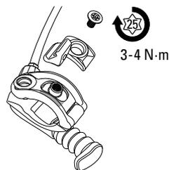
**Leva freno** - Posizionare la leva del freno contro il manubrio. Chiudere il morsetto remoto attorno al manubrio e alla leva del freno. Inserire il bullone del morsetto remoto e serrare, senza stringere, il bullone per tenere insieme il gruppo. Ruotare il morsetto remoto alla posizione desiderata e utilizzare un T25 TORX per serrare il bullone di bloccaggio a 5-6 N-m.
