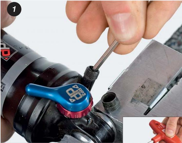
Spannen Sie den ausgebauten Dämpfer mit dem oberen Dämpferauge in einen Schraubstock.
