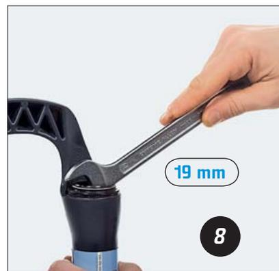
**TIPP** Mit einem 19-Millimeter-Maulschlüssel lassen sich die alten Abstreifer leicht heraushebeln.
